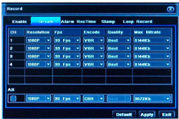
Nastavte hodnotu, řešení, kvalitu, šifrování a maximální přenosový záznam. Uživatel může nastavit všem kanálům stejné parametry, zaškrtněte „All“ pro relevantní nastavení. Klikněte na „default“ pro resetování nastavení. „Apply“ pro uložení nastavení, a „exit“ pro ukončení.
