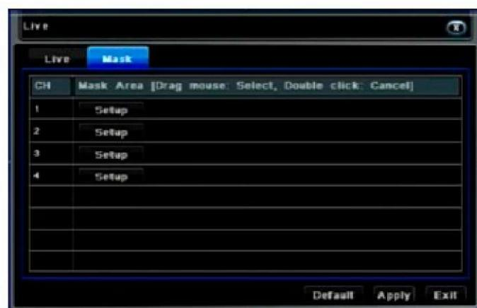
**Nastavení oblasti masky:** Stiskněte tlačítko nastavení, zapněte si živý obraz na kameře a táhněte myší pro označení oblasti. Odkazujte se na obrázek níže.
