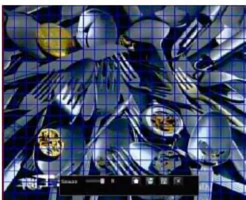
V oblasti rozhraní nastavení, uživatel může táhnout posuvník k úpravě citlivosti hodnoty (1-5), základní hodnota je 4. Citlivost je ovlivněna časem (den nebo noc), uživatelé mohou upravit záznam do aktuální situace. Klikněte na ikonu „hvězdy“ a nastavte všechny oblasti pro rozsah detekce. Klikněte na „koš“, tím smažete nastavení. Kliknutím na „disketu“ uložíte nastavení. Kliknutím na „křížek“ ukončíte aktuální rozhranní.
