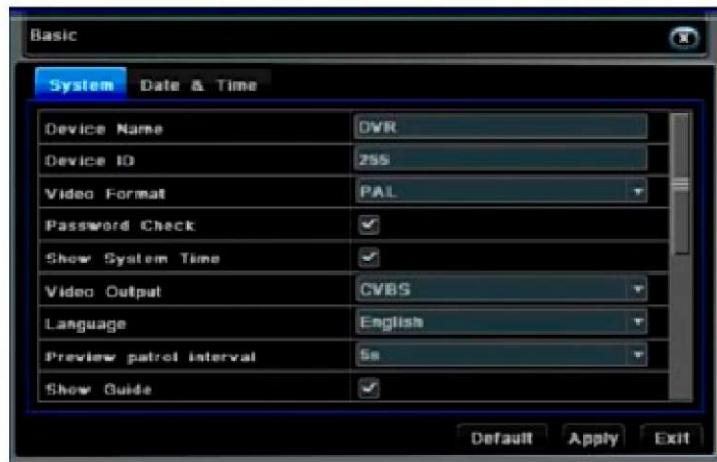
V tomto rozhraní může uživatel nastavit jméno zařízení, ID zařízení, formát videa, maximální počet online uživatelů, video výstup a jazyk, spořič obrazovky a další. Definice pro každý parametr jsou níže.
