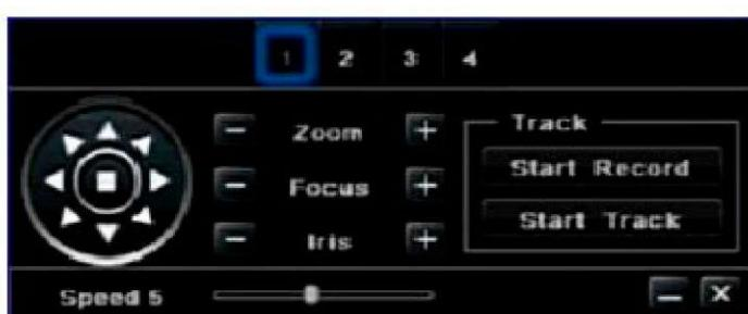
Uživatel může řídit PTZ zařízení: nahoru, dolů, doleva, doprava. Může upravit rychlosť otáčení a hodnotu přiblížení. Soustředění a duhovku kupole. Klikněte na „start record“ pro záznam pohybující se stopy PTZ, opětovným kliknutím se záznam stopne. Uživatel může táhnout posuvník pro úpravu PTZ pohyblivosti.
